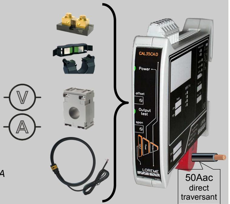
Le CAL35CAD permet la mesure d'une tension ou d'un courant alternatif et sa transposition en un signal normalisé (0 ... 4 ... 20 mA ou 0 ... 10 V) proportionnel à la valeur efficace du signal d'entrée. L'utilisation du transformateur traversant intégré (optionnel) ou du capteur de ROGOWSKI permet une mesure directe sans transformateur externe.
